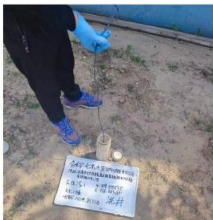
S1洗井照片
