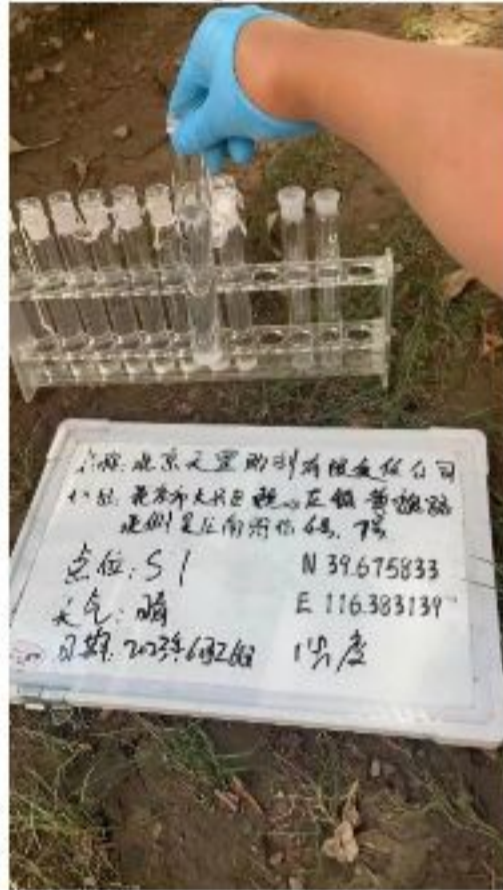
S1洗井浊度参数照片
